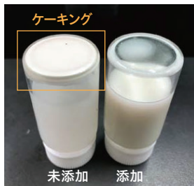
BiNFi-sセルロースによる ケーキング防止効果
