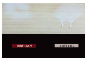
BiNFi-sの添加による 液だれ防止効果
